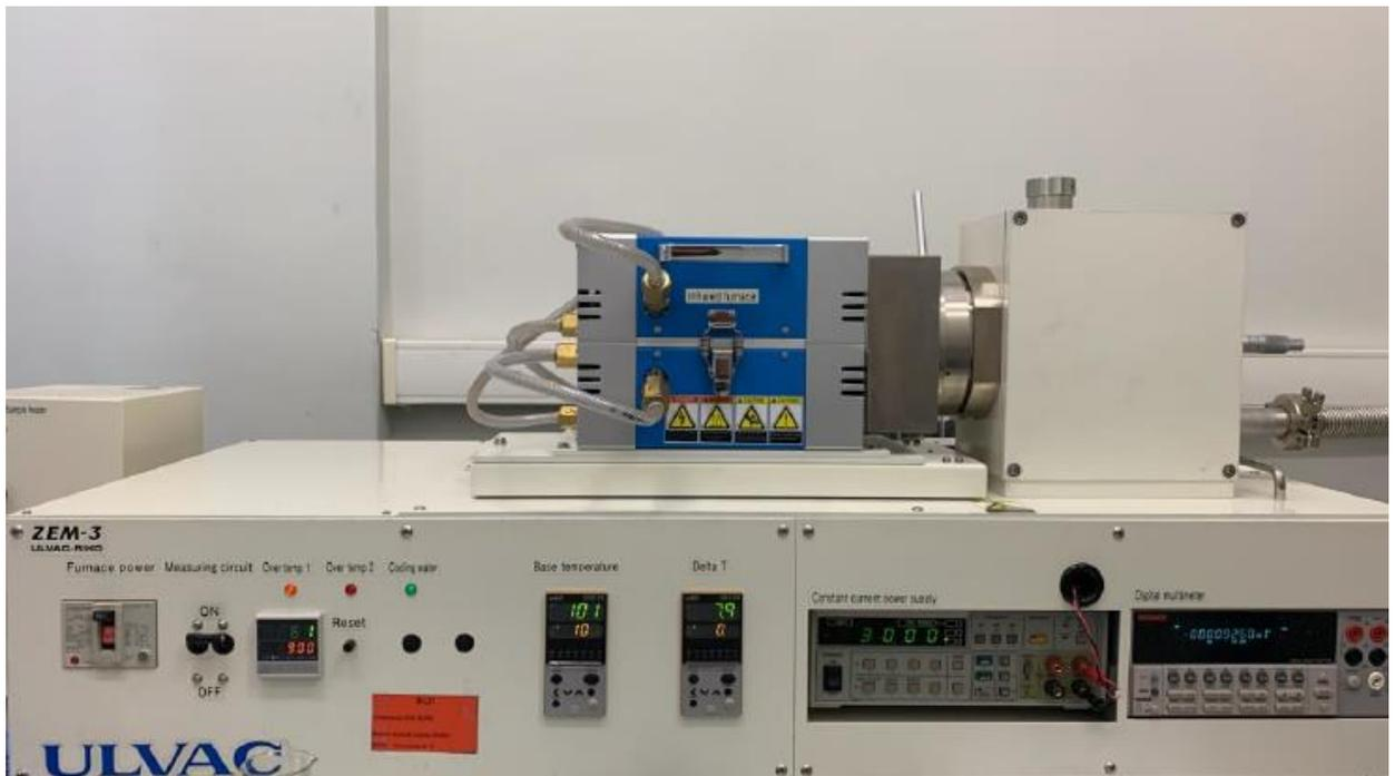
*Рисунок 2. Измерительный комплекс для исследования термоэлектрических параметров материалов. Интервал рабочих температур от +25°C до + 800°C*
