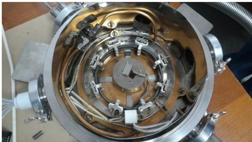
**Рисунок 15. Измерительная ячейка для исследования КПД термоэлектрических устройств и тепло электрофизических параметров материалов**
