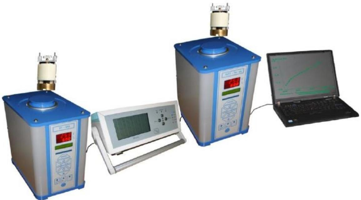
***Рисунок 11. Измерительный комплекс для исследования термоэлектрических параметров материалов. Интервал рабочих температур от минус 60° С до + 400° С***
