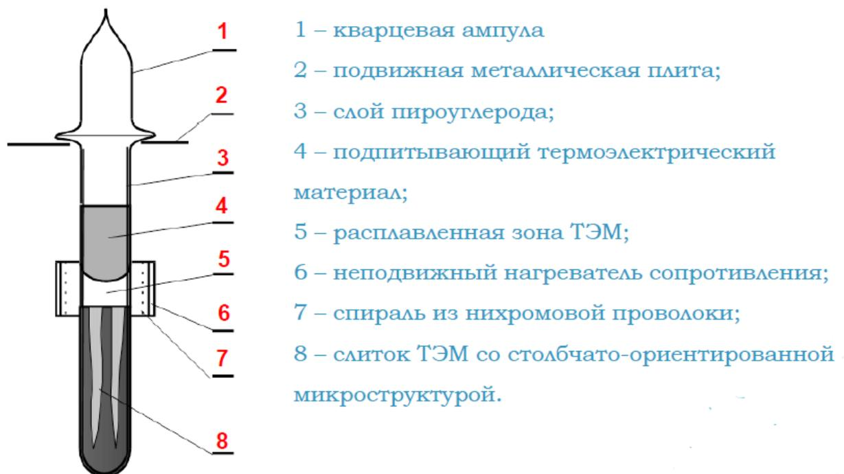
*Рисунок 3. Устройство синтеза*
